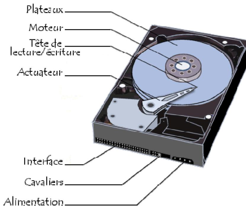
Il est composé de plusieurs disques de métal appelés **plateaux**. Ces derniers sont eux-mêmes recouverts de matériaux magnétiques sur lesquels sont stockées les données. Chaque face du plateau est composée de **têtes de lecture/écriture** montées sur des bras (actuateurs).
